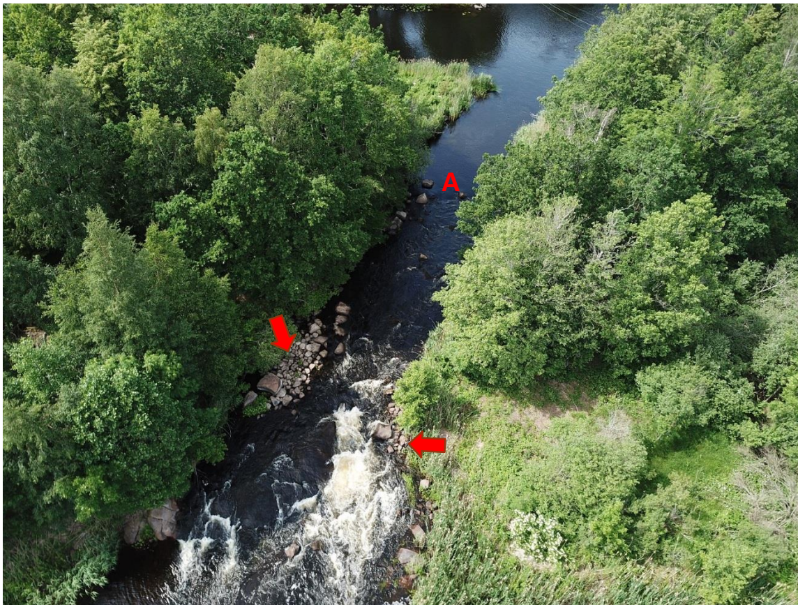
Figur 31. Den mindre av fårorna inom Emsfors gamla dämningssområde. Genom biotopvård kan en större lek- och uppväxtyta skapas. Befintligt uppensat stenmaterial (se pilar) sprids ut, framförallt längre uppströms men även nedanför fallet. Målet är att jämna ut nuvarande hårda fallprofil i den nedre delen så att strömhastigheten fördelas över en längre sträcka vilket ökar ytan uppväxtområden. Lekbotten etableras sedan i sträckans ovandel (A) med hjälp av helikopter i samband med övriga åtgärdslokaler där detta föreslås.
