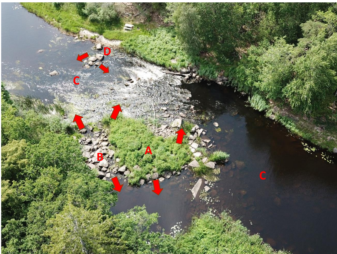
Figur 30. Målsättningen är att nuvarande strömnacke och strömvattenbiotop ska utökas så att vattnet sprids över hela ytan. Det innebär att den yta som idag är torrlagd med mindre buskvegetation (A) ska bli ett grundområde och att området på den östra sidan (B) ska bli mera vattenförande. Detta område öppnas upp något och block sprids ut upp- och nedströms. Därmed ökar strömnackens bredd betydligt och den tillgängliga strömvattenbiotopen. Enstaka större s.k. ståndplatsstenar kan med fördel läggas ut i det lugna området framför strömnacken samt i området nedanför strömsträckan (C). Även de stora block som ligger i en revel på den västra stranden bör spridas ut. Detta inte minst för att skapa bra fiskeplatser. Lekkottenetablering bör sedan ske vilket bäst utförs med helikopter. Val av lämpliga platser sker efter restaurering av området.
