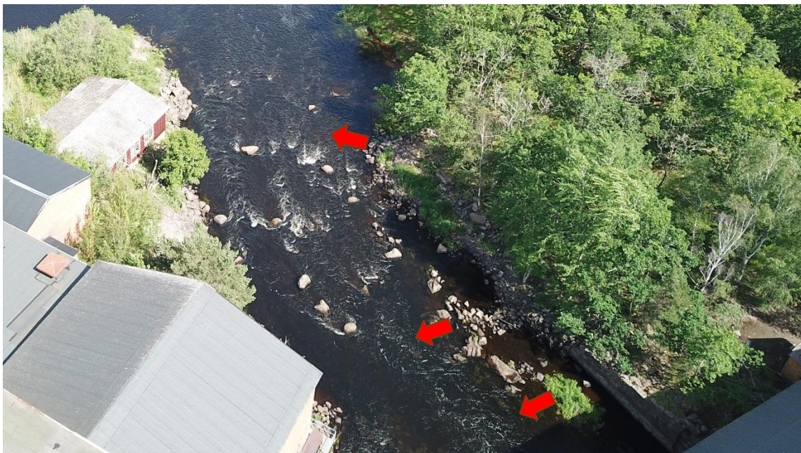
Figur 23. Den nedre delen på åtgärdslokal 3A. den tillgängliga strömsträckan kan breddas genom att sprida ut de block som finns på den södra kanten, se pilar. På så sätt får man bättre uppväxtområden även utefter den södra sidan av ån. Lättillgängligt från den södra sidan.
