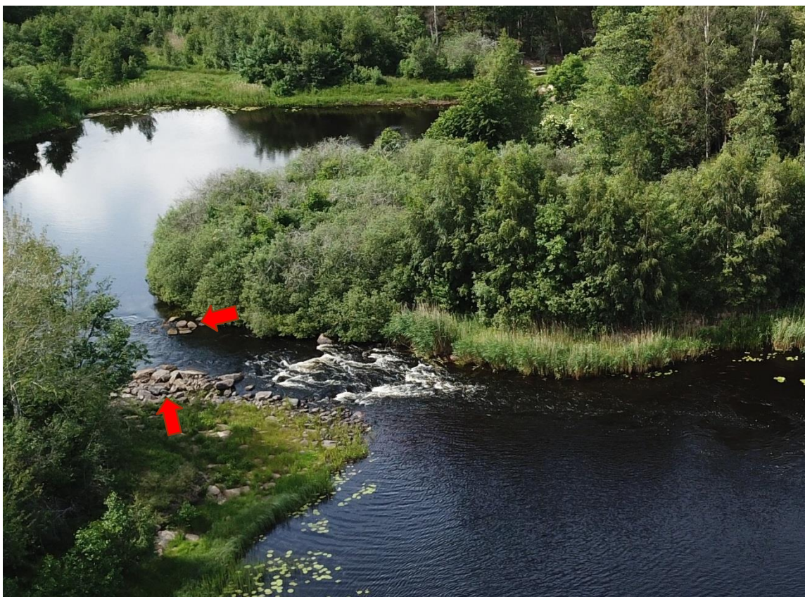
Figur 28. Den södra strömnacken. Block ligger i högar vilka kan spridas ut för att skapa en längre strömsträcka. En restaurering skulle sprida vattnet över en större yta.
