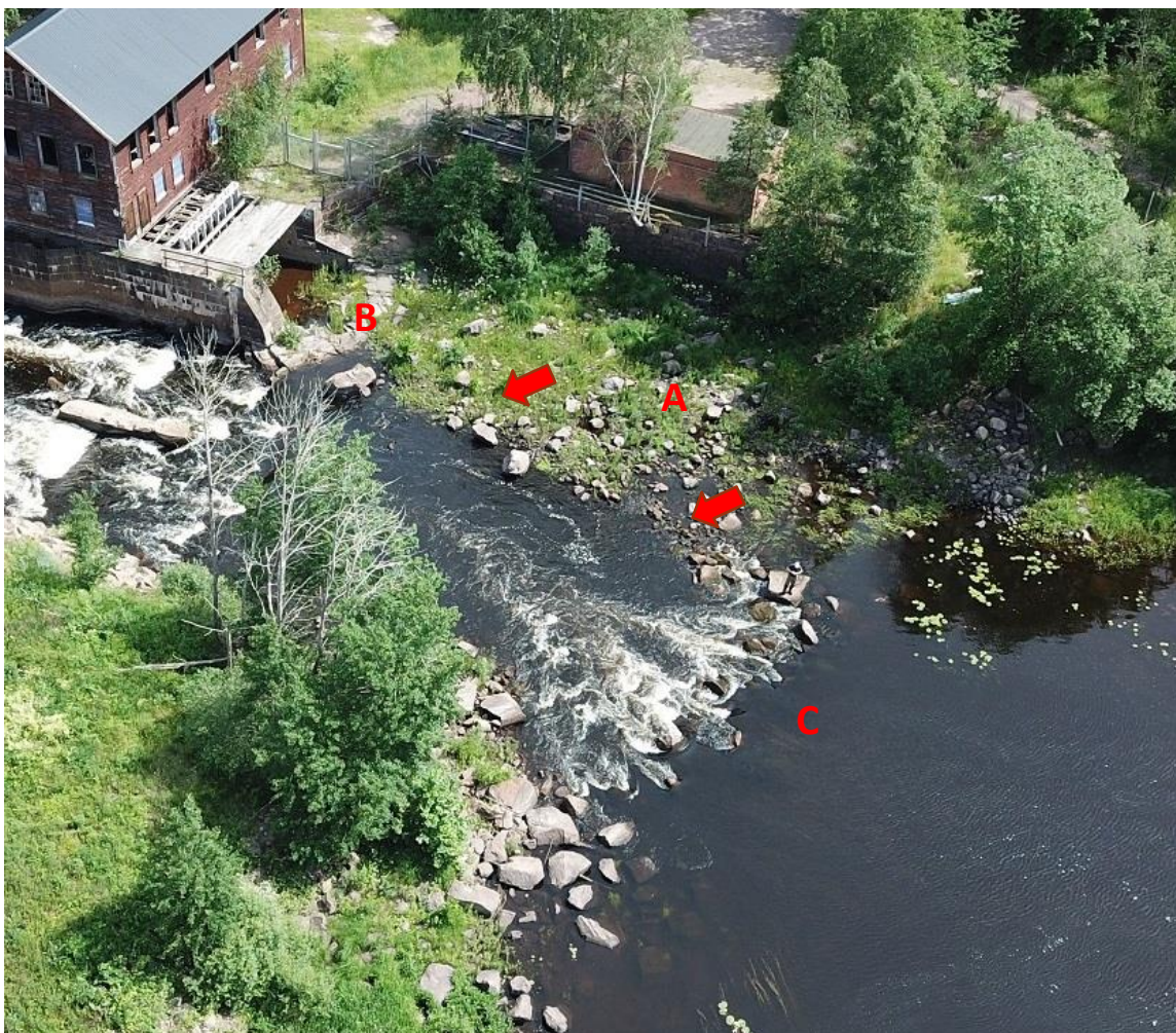
Figur 27. Området kan breddas genom att stenmaterial flyttas om så att en större strömvattenmiljö och därmed uppväxtyta för laxfisk skapas. Stenmaterial från det södra området (A) flyttas om och sprids ut så att hela detta område blir vattenförande. Området närmast det gamla turbinintaget (B) lämnas orört. Den kraftigt uppbyggda övre strömnacken (C) som består av stora block i en rad jämnas ut genom att mera stenmaterial i olika fraktioner sprids ut upp- och nedströms. På uppströmssidan av strömnacken etableras avslutningsvis lekbottnar för laxfisk.
