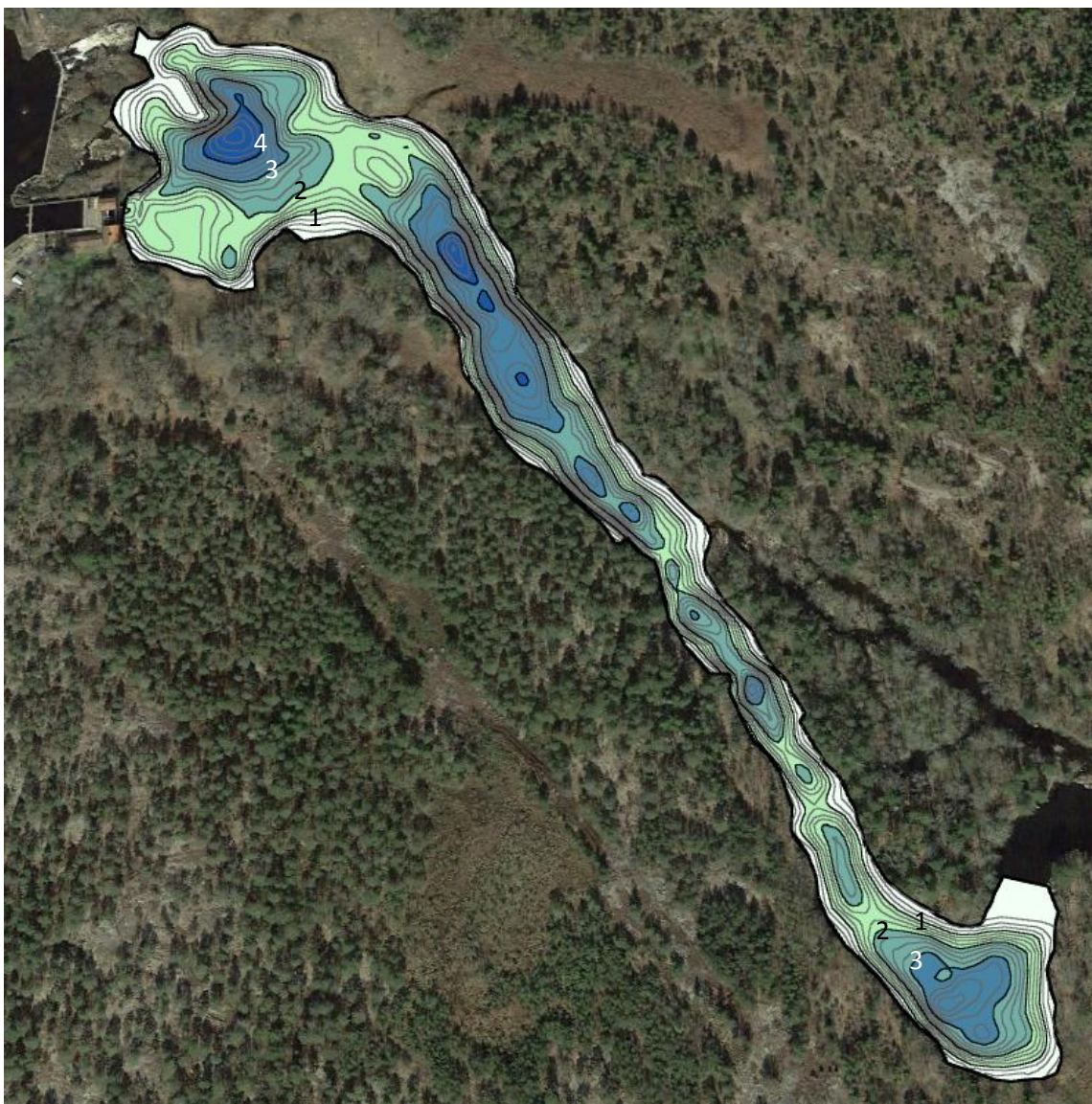
Figur 38. Djupkarta över Emån nedströms Karlshammar kraftverk. Maxdjupet är drygt 4 meter och i mellersta och nedre delen av sträckan finns några grundtrösklar mellan 1-1,7 m djup.
